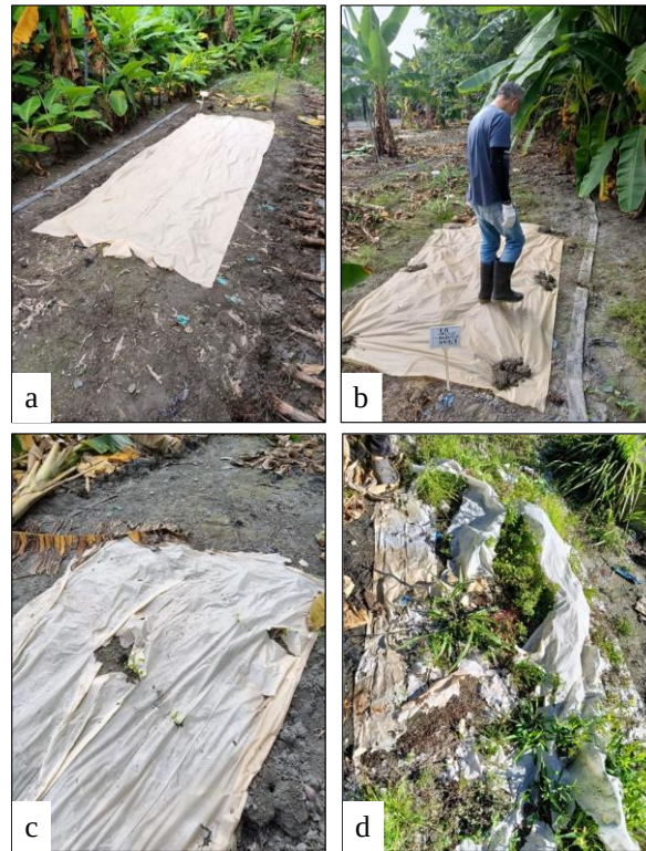
圖 19、可生物分解農膜建立與測試：(a)農膜鋪設；(b)模擬農民田間行走畦上，測試農膜的強韌度；(c)農膜於 1 週後開始分解；(d)農膜於 1 個月後完全分解。
