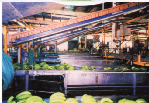
圖四、為進行集團蕉園機械化，擬從澳洲引進之套袋機（上），果房搬運車（中）及自動化包裝設備（下）。
