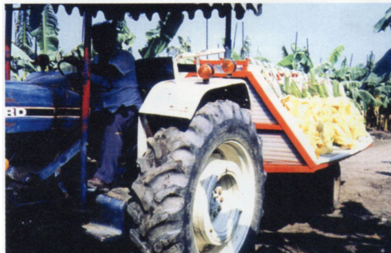
圖 5.為配合集團蕉園所設計的採收搬運車，由曳引機與拖車聯結而成，可減少果把擦壓傷，並達省工目的。
